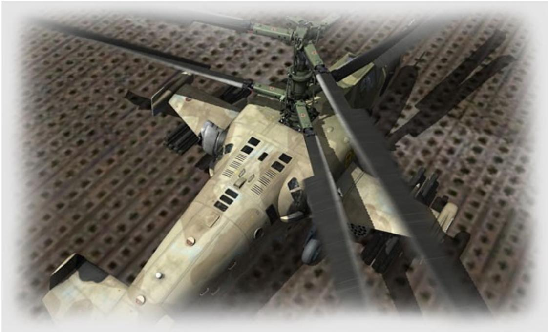
In Hovering i due dischi rotorici del Ka-50 sono progettati in modo da produrre la stessa quantità di torque ma in verso opposto. Da progetto le pale inferiori hanno un angolo di passo di circa 1.25 gradi maggiore rispetto alle pale superiori di modo che la produzione di torque si equivalga in hovering (a livello del mare in aria standard).
