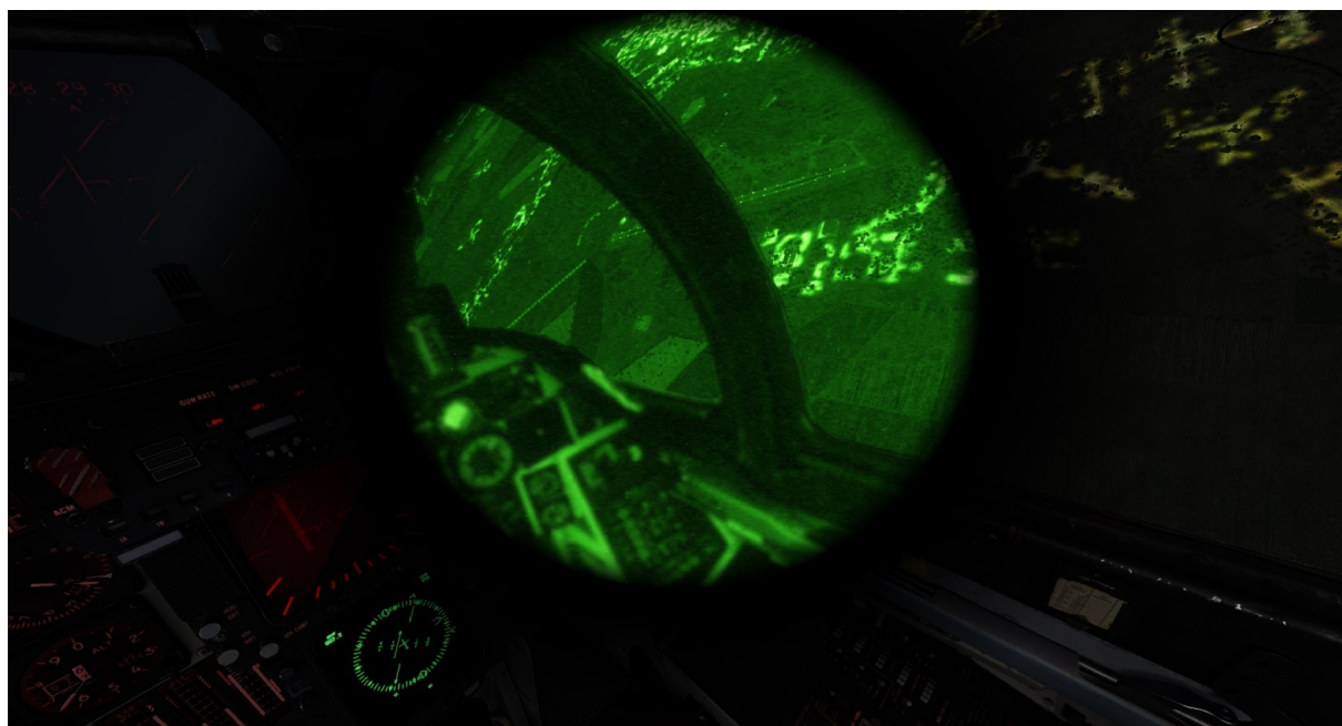
Figura 9: Esempio di vista con NVG tra cockpit e suolo
