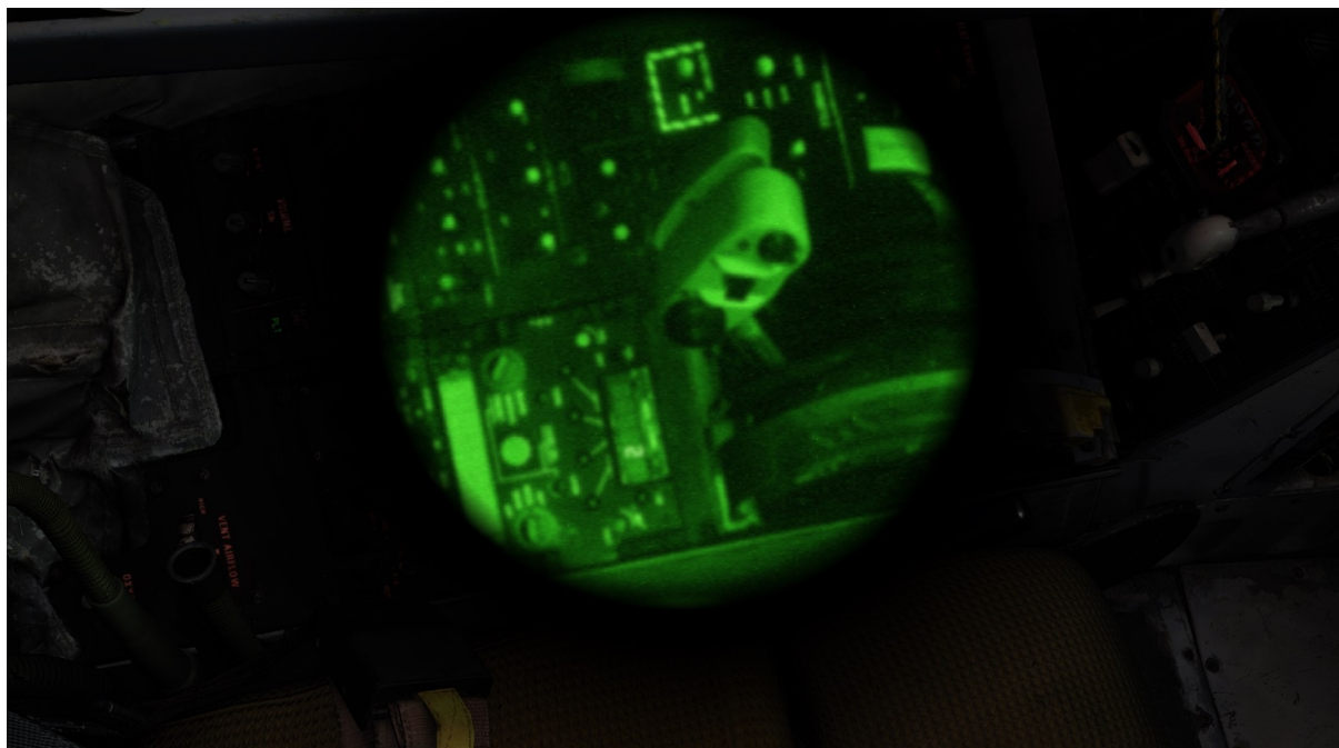
Figura 8: Particolare display radio con le stesse impostazioni luminose NVG della figura 6
