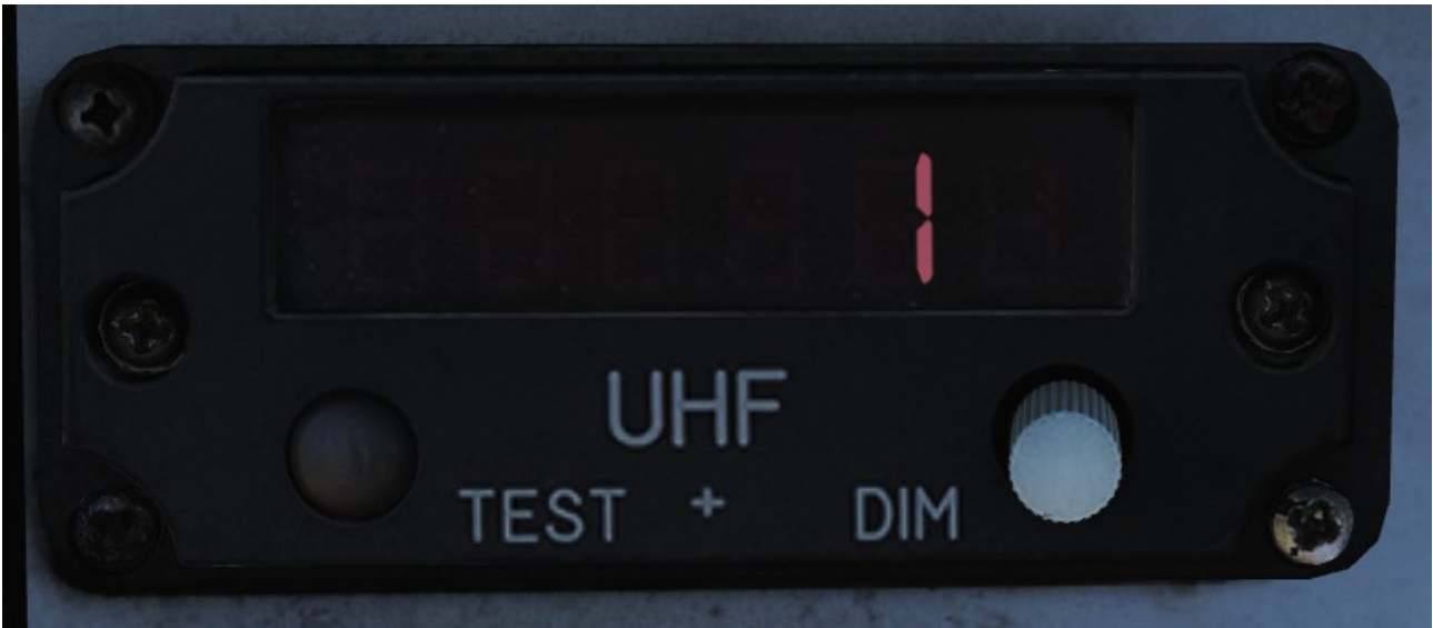
Figura 7: ndicatore remoto della frequenza o del canale PRESET della radio V/UHF2 del R.I.O., sul pannello frontale sinistro.
