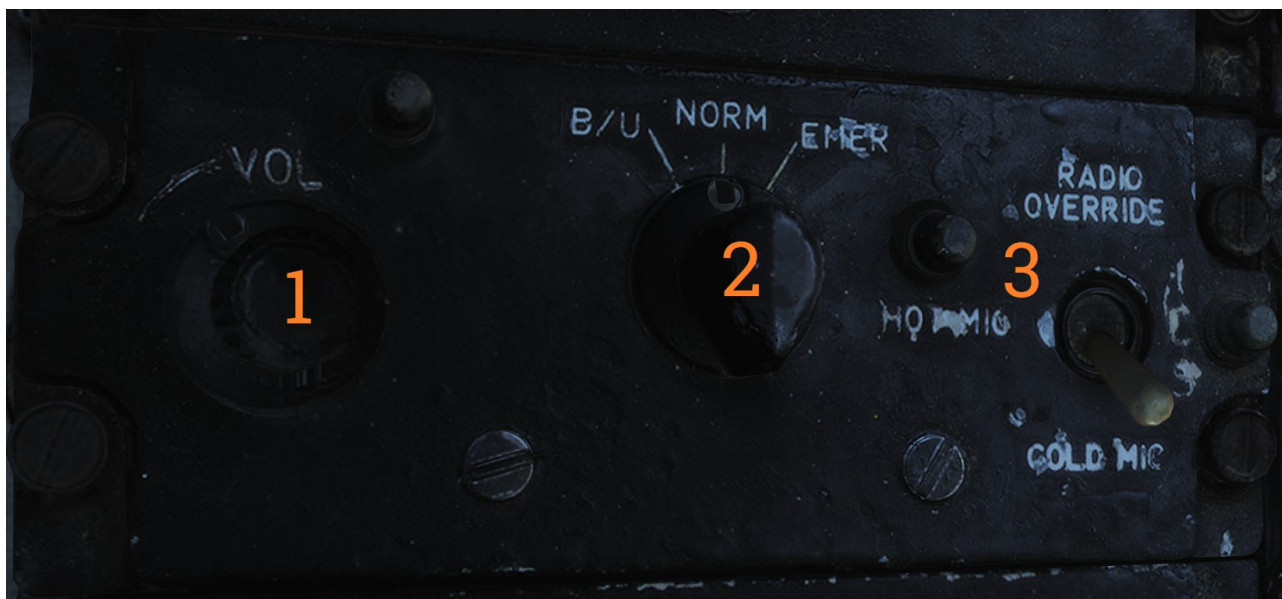
Figura 3: Pannello di controllo I.C.S., sulla consolle laterale sinistra.
