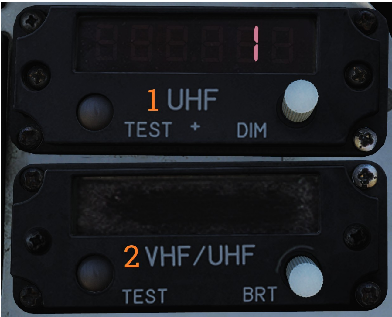
Figura 4: Indicatori remoti delle frequenze o canali PRESET delle radio UHF1 e V/UHF2, sul pannello frontale destro.
