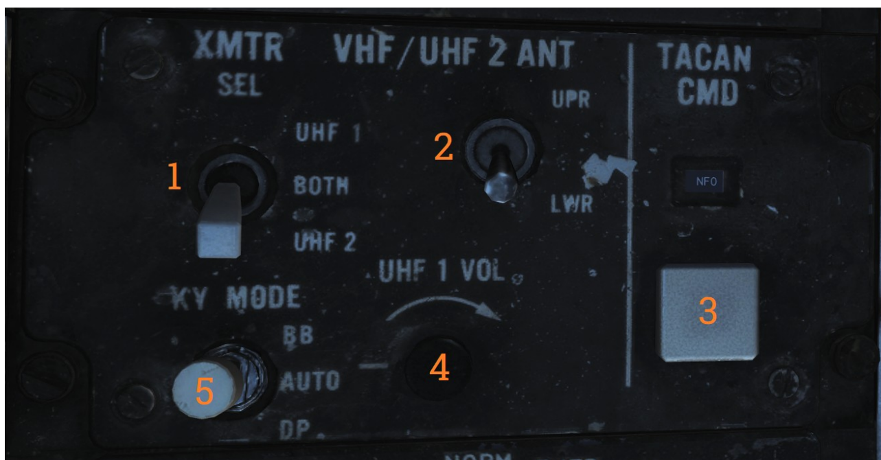
Figura 8: Pannello di comando comunicazioni/TACAN, consolle laterale sinistra.
