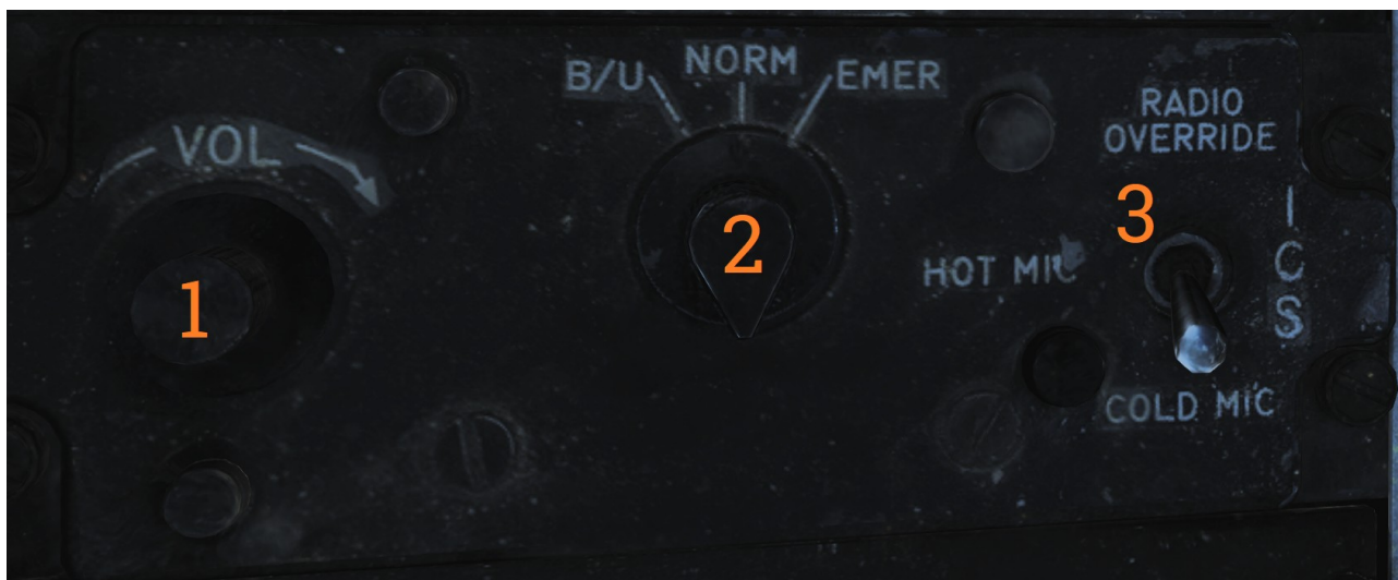
Figura 6: Pannello di controllo ICS, sulla consolle laterale sinistra.
